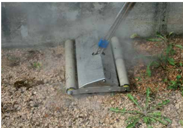
▲ Pour remplacer le désherbage, un désherbeur thermique à la vapeur
