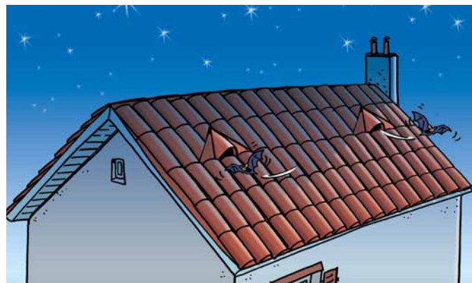
▲ Chiroptière tuile spéciale permettant l'accès des combles de la maison par les chauves-souris
